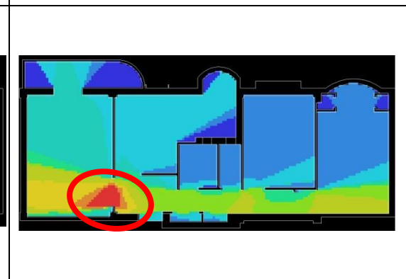
Figure n° 4: Intégration -Intégration importante au niveau de l'intersection du hall et du séjour. -Intégration acceptable au niveau des
