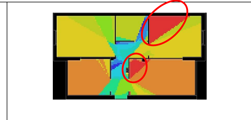
Figure n° 6: Entropie La figure n° 6 illustre un ensemble d'espaces illisibles et inaccessibles représentés sur la carte par la couleur rouge (une partie de la chambre 2 et du séjour) Ces derniers sont appuyés par une valeur moyenne de: 1,57.
