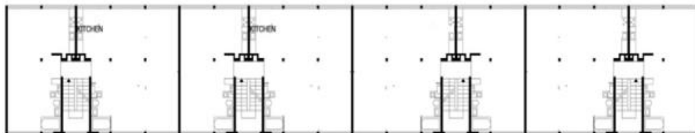
Figure 4.10 : Projet Weissenhofsiedlung de Mies van der Rohe, 1927 en Allemagne, qui montre l'utilisation du système souple avec des espaces indéterminés libres.
