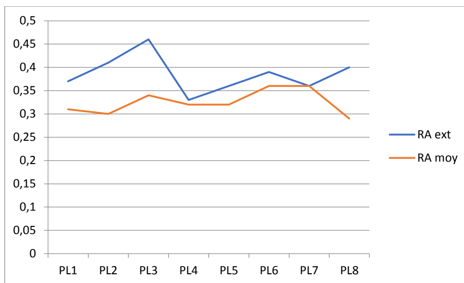
Figure 8.10 : La perméabilité du système depuis l'extérieur sur l'échantillon du LPL variante 2. Source : Auteur, 2021
