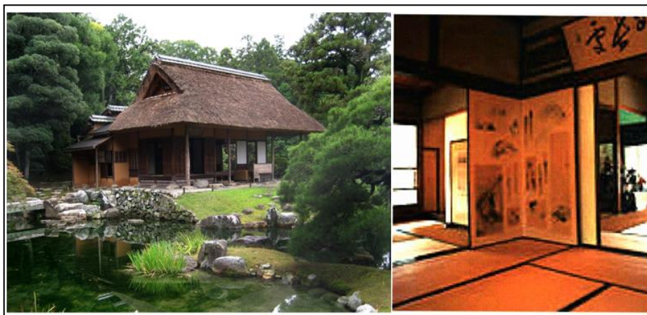
Figure 4.1 : Espace intérieur d'une minka, organisé selon une trame aux dimensions des tatamis. Source : Barthelemy, 2004
