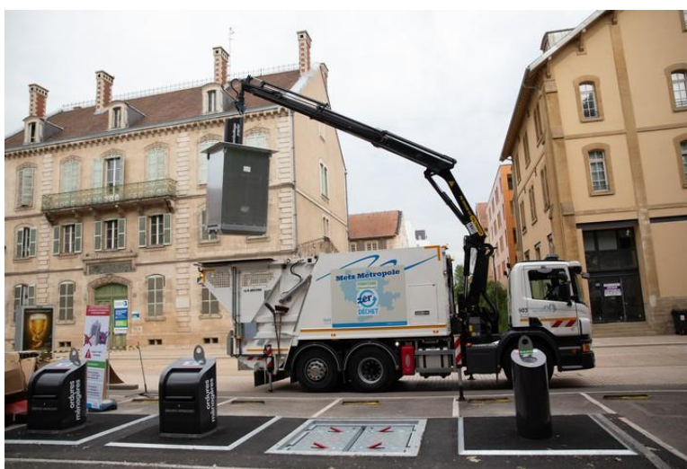
Figure 5.19: Camion à benne tasseuse avec bras de levage munie d'une pince de KINSHOFERT pour l'enlèvement des bornes d'apport volontaire.
