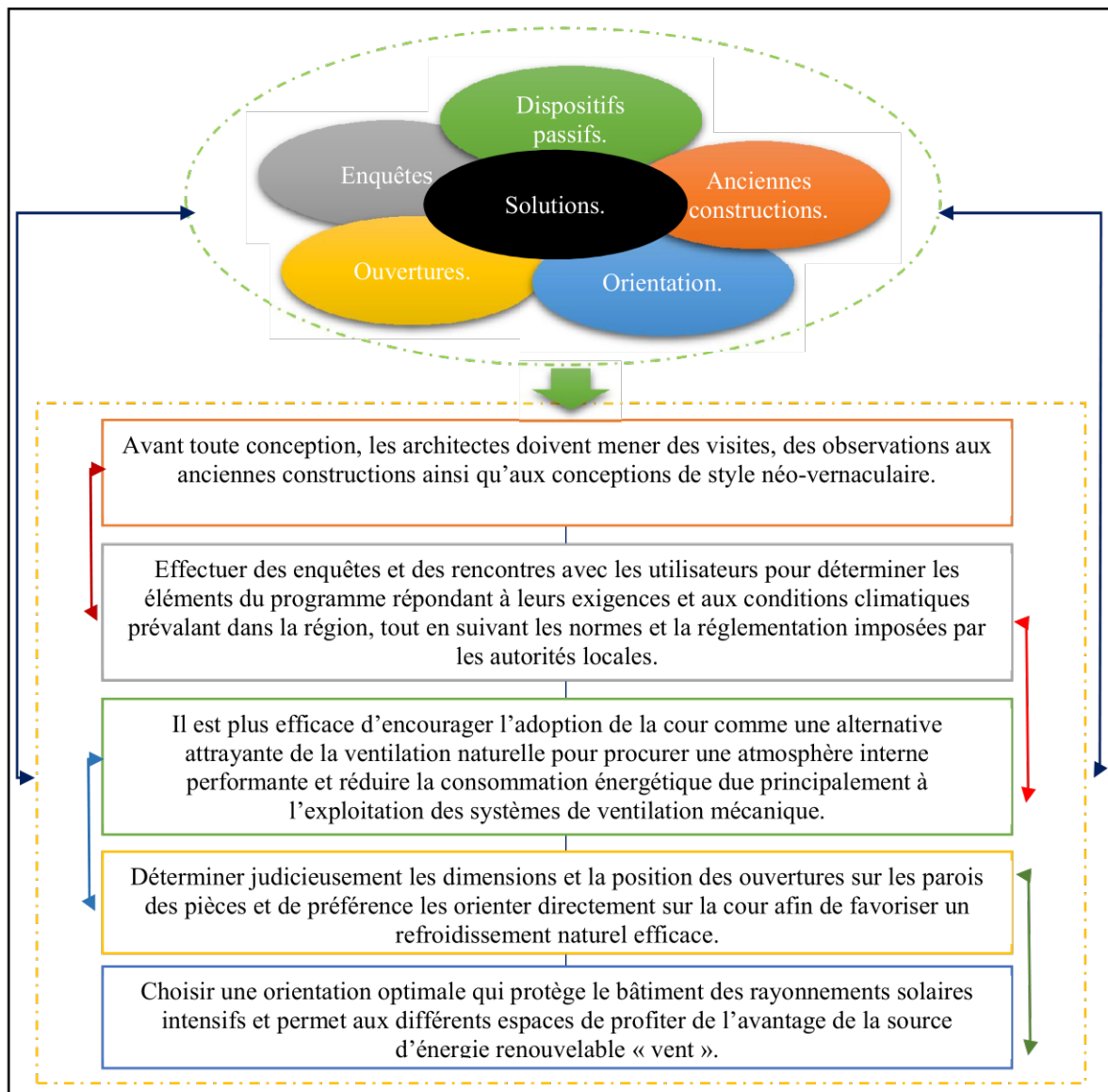
Figure 7. 6 : Quelques recommandations suggérées pour assurer la ventilation naturelle à l'intérieur des futurs logements.
