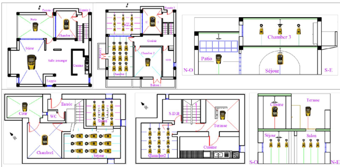
Figure 5. 4 : Démonstration du positionnement des appareils d'instrumentation au niveau du plan et de la coupe du logement duplex et le logement Siddi Abbaz.
